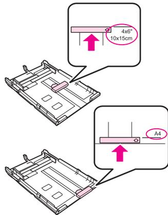
3. 將紙張可列印面朝下，朝紙張邊緣定位器放入，然後確認紙張沒有超出紙匣的末端。
