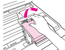
5. 壓住墨水卡匣的卡榫，將墨水卡匣從印表機中取出。
